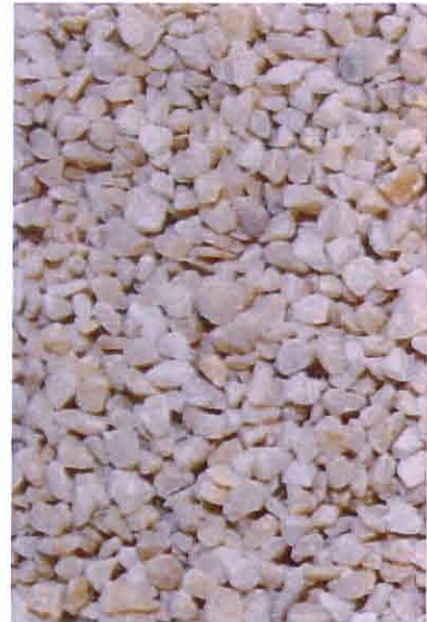
Als Filtermaterial eingesetzter Jurakalk
